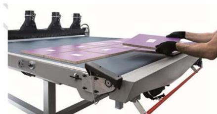
Разгрузочный Коврик для панелей обеспечивает вывод фрезерованных панелей за пределы рабочей
